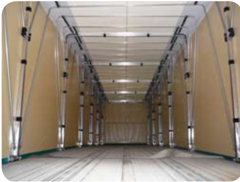
Vista interior de la unidad mostrando los arcos plegables dobles opcionales y el techo translúcido standard.
