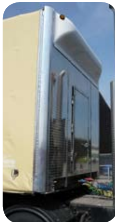
Panel delantero con deflector standard y puerta de acceso.
