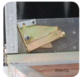
La cerradura trasera le brinda la posibilidad de tensionar mejor la lona.
