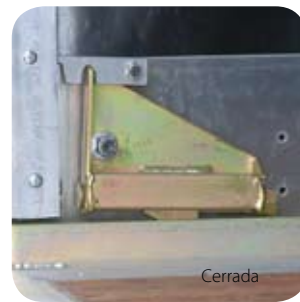
La cerradura trasera le brinda la posibilidad de tensionar mejor la lona.
