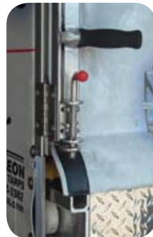
Sistemas de cierre ergonómicos en las puertas traseras.
